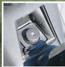
Spremnik goriva zapremine 12,5 litara smješten je ispod upravljača
