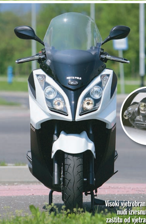
Kočnice su izvrsne iako je na prednjem kotaču samo jedan disk promjera 260 mm
