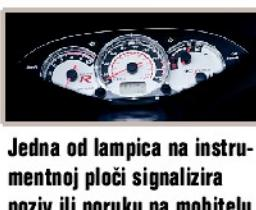
Jedna od lampica na instrumentnoj ploči signalizira poziv ili poruku na mobitelu
