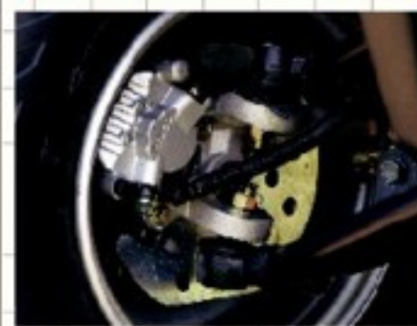
Prednja ramena i diskovi nisu pretrpjeli oštećenja
