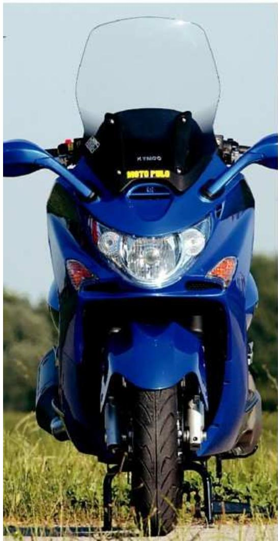
120/70 sprijeda te 150/70 straga. Kočenje je integralnog tipa, s tri diska, od kojih su prednja dva promjera 260 mm, dok se straga nalazi jedan disk od 240 mm. Na diskove djeluju kočione čeljusti sa po dva klipića na koje se, već serijski, ugraduju kočiona crijeva s metalnom pletenicom. Stražnji amortizeri su obilnih dimenzija i mogu se podešavati u 5 položaja djelovanjem na opterećenje opruge.
