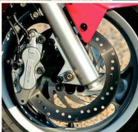
Sustav kočenja je integralan. To se može naslutiti već na prvi pogled po tome što su vidljivi dvostruki hidraulični vodovi na prednjim dvokljpim klještima
