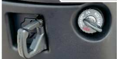
Na stražnje strane vjetrobranskog štita nalazi se kuka za vješanje torbe kao i praktični otvor za dolijevanje goriva
