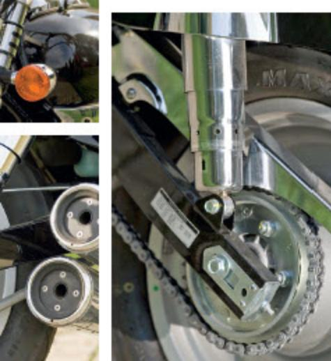
Tajvanski custom karakterizira puni stražnji naplatak, sekundarni prijenos korištenjem lanca umjesto remenice te ispušni topovi nalik na trube
